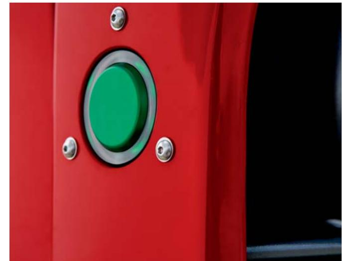
/ Como novidade temos nossa função voltada para o usuário MDE (Magirus direct-entry - entrada direta) nas escadas giratórias articuladas. Através do botão de controle MDE no lado direito da cabine, o cesto pode ser automaticamente baixado para posição de nível de entrada na frente da cabine.
