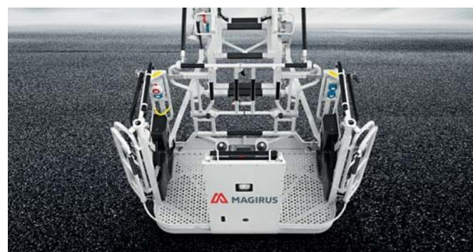
/ Duas entradas para o cesto separadas com portas dobráveis nas laterais e barras de proteção garantem acesso livre - importante para quem usa equipamento de respiração.
