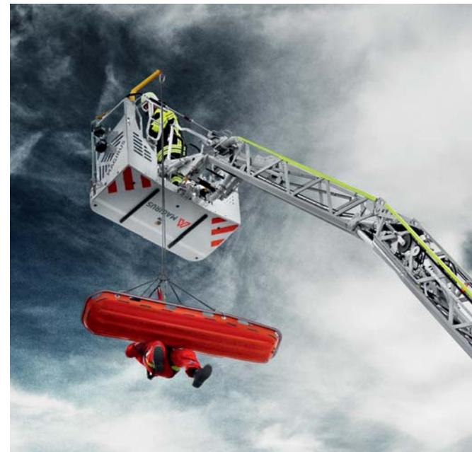
/ A função de resgate em poços permite um içamento completamente perpendicular - por exemplo, para resgatar pessoas em segurança de poços ou fossos. O controle da escada mantém a posição vertical automaticamente e com alta precisão; o ajuste manual não se faz necessário.
