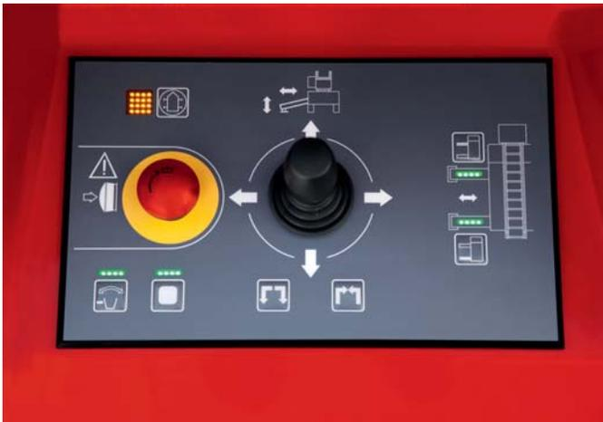
/ O painel de controle intuitivo é integrado a traseira do veículo e com proteção apropriada contra intempéries. O joystick ergonômico otimizado pode ser operado facilmente com luvas.
