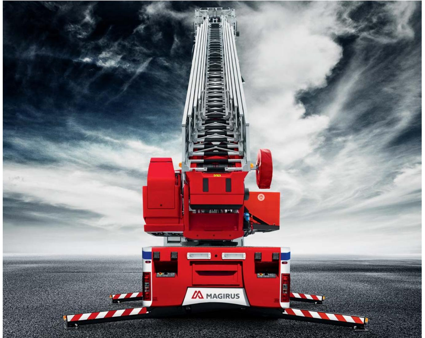
/ Cada centímetro adicional nos apoios aumenta o alcance potencial e, portanto, a área de trabalho e útil da escada. O controle automático de nivelamento de até 10° e a área de trabalho abaixo do solo de -17° permitem alcance máximo - sem erguer os eixos ou outras soluções emergenciais.
