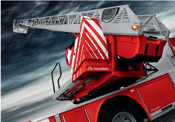
/ Cada centímetro adicional nos apoios aumenta o alcance potencial e, portanto, a área de trabalho e útil da escada. O controle automático de nivelamento de até 10° e a área de trabalho abaixo do solo de -17° permitem alcance máximo - sem erguer os eixos ou outras soluções emergenciais.
