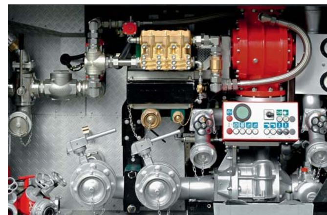
/ Bombas de combate a incêndio e proporcionadores de espuma integrados transformam a escada em equipamentos de alto desempenho durante missões de combate (opcional).
