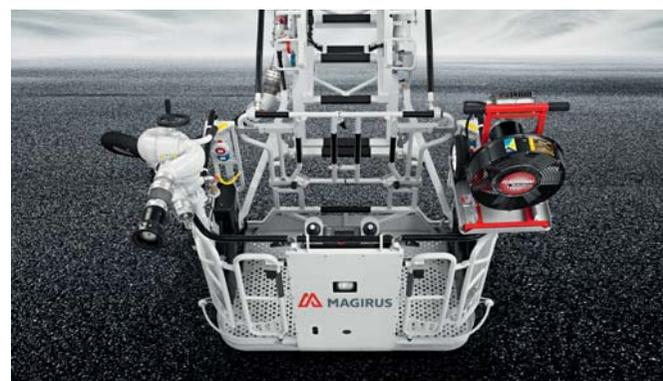
/ As duas colunas multifuncionais podem ser usadas para montagem tanto do suporte de maca quanto do monitor de água e um ventilador de pressão positiva de forma simultânea.
