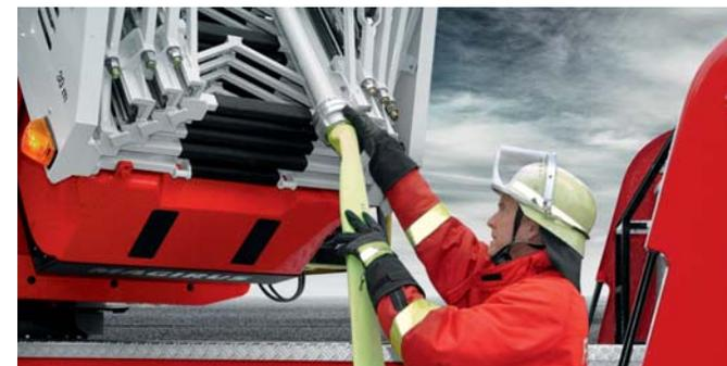
/ A mangueira pode ser facilmente acoplada a partir do solo ao tubo permanentemente instalado. Quando a escada é estendida a mangueira é erguida em conjunto. Há um guia para mangueira disponível como opcional.
