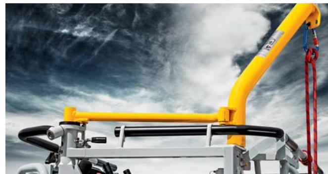
/ O Safety Peak Magirus, uma barra de proteção opcional montada no cesto, permite um trabalho mais conveniente e seguro no cesto durante o resgate e também proteção contra quedas. Uma maca cesto, por exemplo, pode ser montada no Safety Peak.
