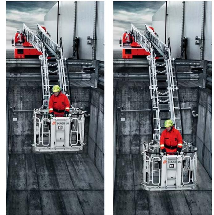
/ Comparação da profundidade de penetração de uma escada com braço articulado e com braço articulado telescópico (esquerda/direita).
