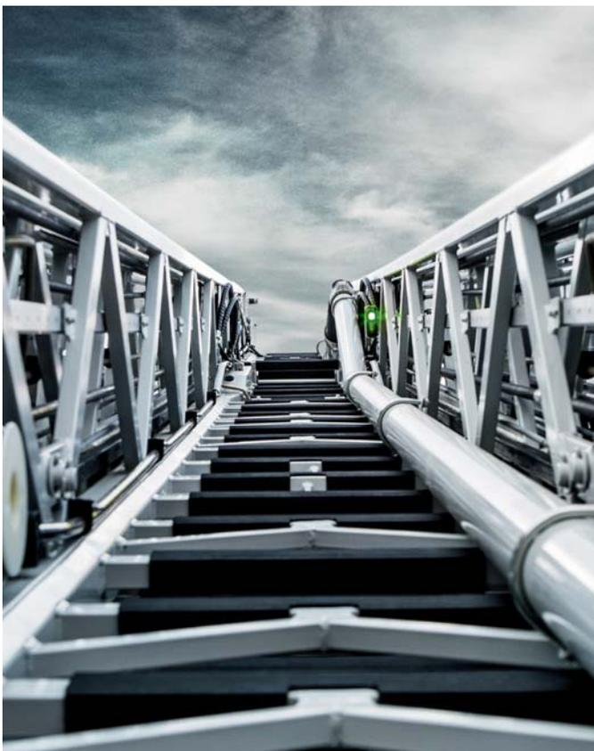
/ Não há locais para tropeçar na área de subida da escada; nenhum componente ou cilindro hidráulico que restrinja o campo de movimento. Corrimãos elevados aumentam ainda mais a segurança. Um circuito de segurança com função de semáforo (opcional) assegura uma movimentação sem riscos no corpo da escada.
